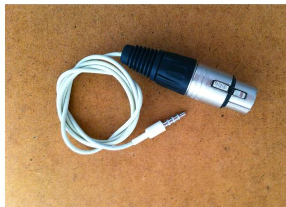
Une fois le petit câble réalisé, il faut lui ajouter une atténuation de 40 à 60 dB en branchant le tout à la sortie Tc du recorder, ici, un SX-R4 Sonosax. (une magnifique machine...)
